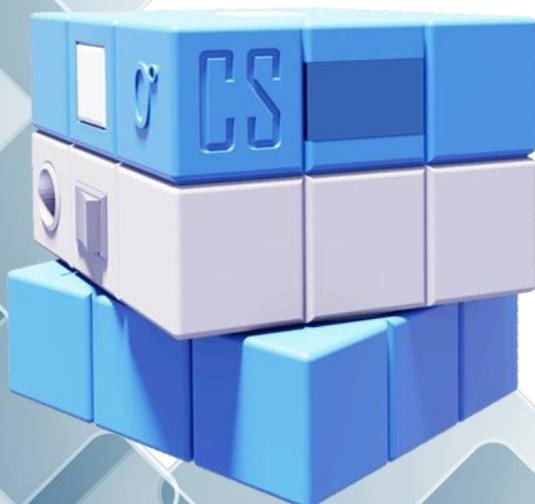
Основное назначение "Cube Sensor" – точное измерение вертикальной освещённости на площадке при юстировке света или при проведении измерений для отчётных документов. При включении измеритель проводит автокалибровку – поворачивается на 180 градусов, определяет с помощью встроенных датчиков точное положение граней и возвращается в исходное положение. В этот момент на дисплее отображается надпись «Calibration».
