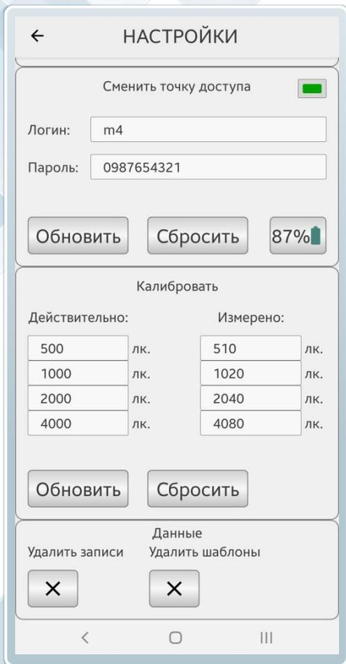
Раздел **Калибровать** позволяет внести поправки в измеряемые значения. Делается это следующим образом:
